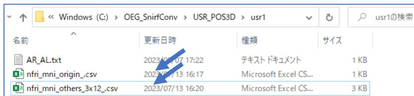
2. 同ホルダーにある AR\_AL.txt ファイルに該当被験者の AR (右耳介前点), AL (左耳介前点) 間の実測距離をメモ帳等を使って入力してください。SNIRF データでは三次元情報は絶対値 (単位はmm) で引き渡す必要があるため、相対値である Spectratech OEG-3DXYZ-OBJ で作成された三次元情報を、この AR、AL 間の実測値を使って絶対値に変換します。
