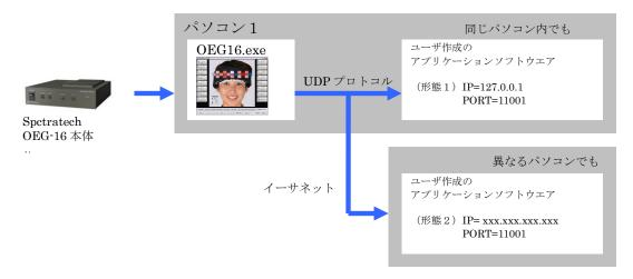
UDP(User Datagram Protocol)とは、インターネットで利用される標準プロトコルの一種で、OSI 参照モデルのトランスポート層にあたります。インターネットでは、一般的にトランスポート層のプロトコルとして TCP が使われますが、UDP も今回の弊社での利用形態のようなリアルタイム性が要求されるストリーミング等で広く利用されています。
