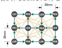
さらには従来からの頭部を $\mu$ A(モル吸光係数)が1つであると仮定する一層モデルではなく、 $\mu$ Aを表皮層と脳内層の2層モデルあるいは3層モデルで解釈し、脳内層信号だけを分離取り出そうとするような最新の研究テーマ向けとして下記のような配置も可能です。(但し、光出射部との距離によっては、SpectratechOEG-16のゲイン調整だけではコントロール出来ない場合もありますので、その場合にはNDフィルター等の光学的な減衰調整が必要な場合もあります。また配置距離によってはセンサーそのものを極細タイプで新たに開発準備する必要があります。そのような場合には弊社までお問い合わせください。)
