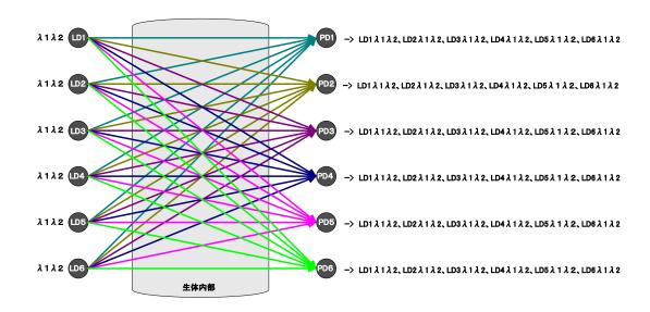
すなわち、Spectratech OEG-16 では光出射部 LD1~LD 6 から出た近赤外光は、光受光部 PD1~PD6 の全てで各信号が強かろうが弱かろうが同時計測されています。よって Spectratech OEG-16 全体としては 6 光出射部 x 6 受光部 = 3 6 チャネルの光波長信号を同時計測していることになります。正確には各光出射部は 2 波長の光源  $\lambda$  1 と  $\lambda$  2 を持っていますので、3 6 x 2 = 7 2 チャネルの光信号を計測していることになります。
