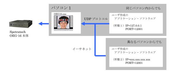
UDP(User Datagram Protocol)とは、インターネットで利用される標準プロトコルの一種で、OSI 参照モデルのトランスポート層にあたります。インターネットでは、一般的にトランスポート層のプロトコルとして TCP が使われますが、UDP も今回の弊社での利用形態のようなリアルタイム性が要求されるストリーミング等で広く利用されています。
